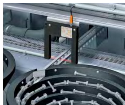
Detección precisa de tornillos en sistemas de alimentación.
