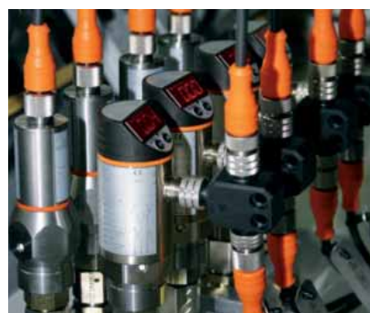
Medición de la presión diferencial en la supervisión de filtros.
