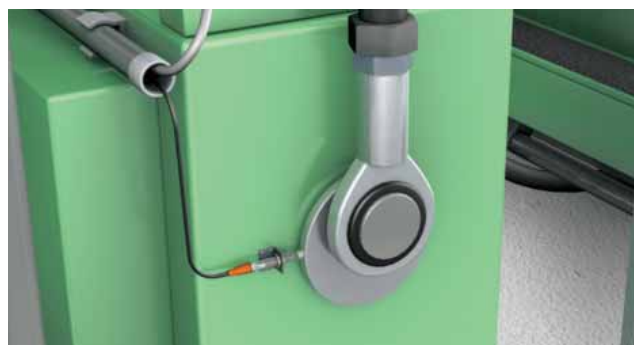
Ejemplo de aplicación: supervisión de la excéntrica.
